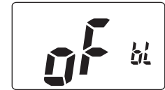
Automatische Beleuchtung OFF
