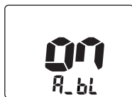
Automatische Beleuchtung EIN (voreingestellt)
