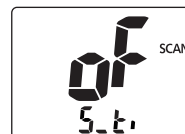
Suchlaufwiederaufnahme-Timer AUS (voreingestellt)
