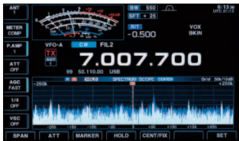
Display mit Spektrumskop im Center-Modus
