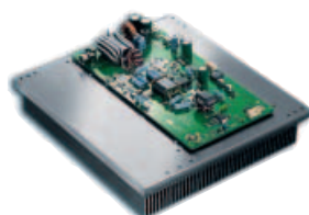
PA-Einheit mit großem Kühlkörper
