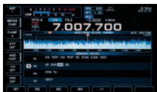
Miniskop-Beispiel • Frequenzanzeige (oben) • Miniskop (Mitte) • Speicher-Keyer-Einstellung (unten)
