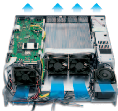
Kühlsystem mit vier Lüftern
