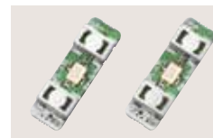
FL-430 1. ZF-FILTER (6 kHz) FL-431 1. ZF-FILTER (3 kHz) Filter für die 1. ZF zur Verbesserung der Empfänger-Performance.
