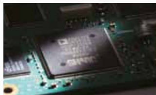
32-Bit-Fließkomma-DSP ADSP-21369 Interne Taktfrequenz: 333 MHz Max. Performance: 2000 MFLOPS
