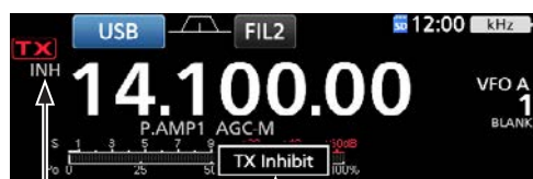
INH-Symbol „TX Inhibit“ wird angezeigt.
