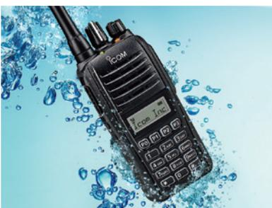
Wasserdicht für 30 Minuten in 1 m Tiefe
