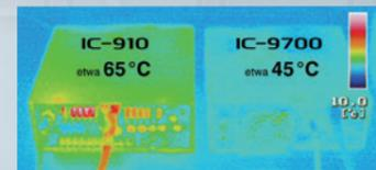
Chassistemperaturen der Rückseiten zweier vergleichbarer Transceiver beim 15-minütigen Dauersenden: Die Temperatur des IC-910\* steigt auf 65 °C, während die des IC-9700 nur 45 °C erreicht. \* Gemessen an der japanischen Version bei 50 W
