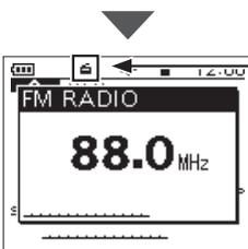
Wird bei eingeschaltetem FM-Rundfunkempfänger angezeigt.
