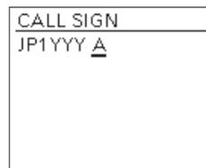
**HINWEIS: ACHTEN SIE DARAUF**, den 8. Buchstaben des Repeater-Nodes entsprechend dem unten gezeigten Frequenzband hinzuzufügen. Cross-Band-Betrieb zwischen verschiedenen Repeater-Nodes am gleichen Standort ist möglich.
