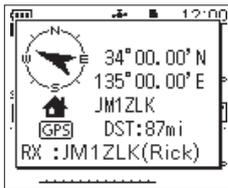
Wenn das Signal empfangen wird, werden die enthaltenen Positionsinformationen im RX-Positionsfenster angezeigt.
