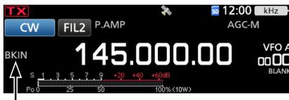
Der ausgewählte Modus (Semi-Break-in) wird angezeigt.
