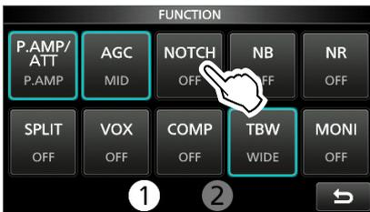
① Bei der Berührung von **[NOTCH]** wird zwischen „AN (Auto Notch)“, „MN (Manual Notch)“ und OFF umgeschaltet.
