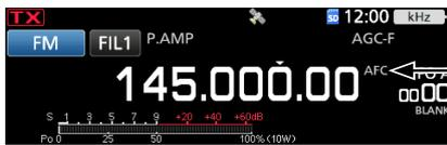
Wird angezeigt, wenn die AFC-Funktion eingeschaltet ist.
