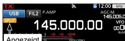
① Das Gerät ist zum Split-Frequenz-Betrieb bereit.
