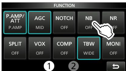
① Wenn Sie **[NB]** berühren, wird die Funktion ein- oder ausgeschaltet.
