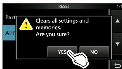
① Nach der Rücksetzung wird der Standard-VFO-Modus-Bildschirm angezeigt.
