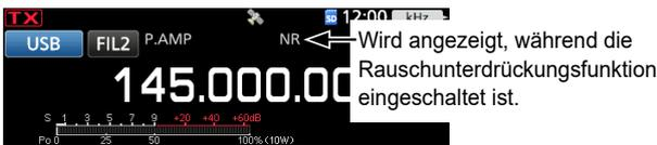
Wird angezeigt, während die Rauschunterdrückungsfunktion eingeschaltet ist.
