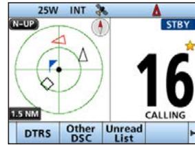
**HINWEIS:** Ein Alarm ertönt, wenn die Entfernung eines AIS-Ziels zum Punkt der größten Annäherung (CPA) und die Zeit bis zum Punkt der größten Annäherung (TCPA) an das eigene Schiff geringer sind, als in den Einstellungen festgelegt. Zum Beenden des Alarms eine beliebige Taste drücken.
