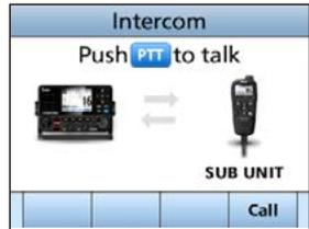
4. Nach dem Loslassen der Softkey unter **Call** die [PTT]-Taste gedrückt halten und in mit normaler Lautstärke in das Mikrofon sprechen.
