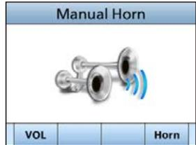
**HINWEIS:** Während des Nebelhorn-Modus sind die Send- und Empfangsfunktionen des Funkgeräts abgeschaltet. Während des Sendens mit dem Funkgerät steht die Nebelhorn-Funktion nicht zur Verfügung.
