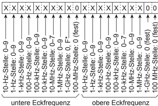
\* „F“ bedeutet, dass die untere Eckfrequenz ein negativer Wert ist.
