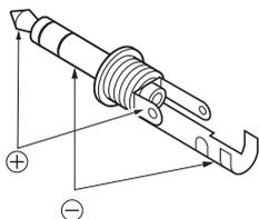
Belegung für den Anschluss eines Paddles zur Bedienung des eingebauten elektronischen Keyers:
