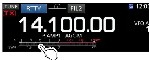
**HINWEIS:** Vor der Messung des SWR die eingestellte Frequenz abhören, um sicherzustellen, dass der Funkverkehr anderer Stationen auf dieser Frequenz nicht gestört wird.
