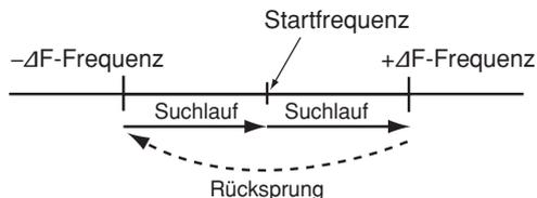
Wiederholter Suchlauf innerhalb des ΔF-Bereichs. Der Suchlauf startet von der Mittenfrequenz aus.
