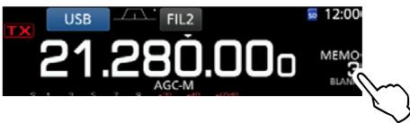
4. Schaltfläche **[M-CLR]** 1 Sek. lang berühren, um den Speicherkanal zu löschen.
