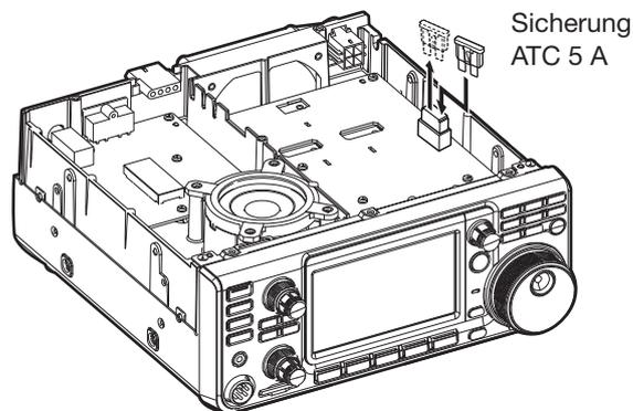
3. Gehäusedeckel wieder mit den 14 Schrauben montieren.
