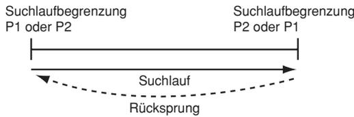
Wiederholter Suchlauf zwischen zwei Suchlauf-Eckfrequenzen. Die Suchlauf-Eckfrequenzen sind werksseitig als P1 und P2 voreingestellt.
