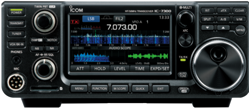
Spektrumskop mit Wasserfall
