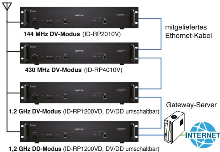
Bis zu vier Module lassen sich an einen Gateway-Server anschließen. Der DD-Repeater muss direkt mit dem Gateway-Server verbunden sein.
