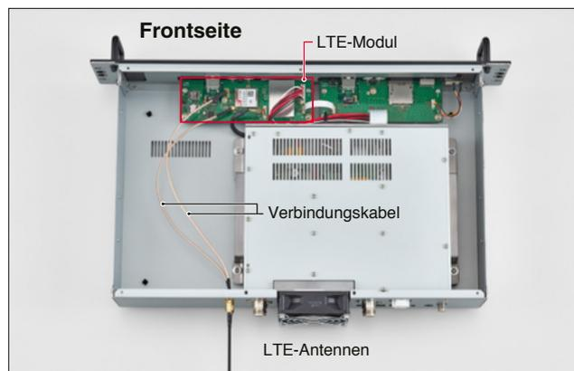
Für den Zugang zum Mobilfunknetz und zum Internet ist eine SIM-Karte erforderlich, die separat zu erwerben ist.
