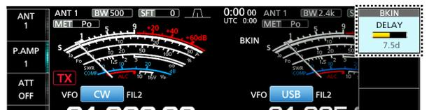
4. Drehen Sie **MULTI** und stellen Sie einen Wert ein, bei dem der Transceiver während des Tastens nicht auf Empfang zurückschaltet.
