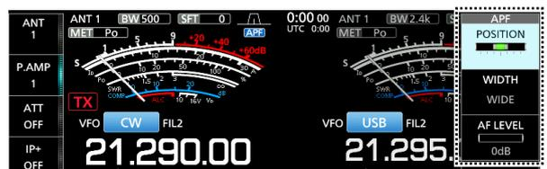
4. Wählen Sie das Element durch Berühren aus und stellen Sie Audiofilterstellung, Durchlassbandbreite und den Audiopegel ein.
