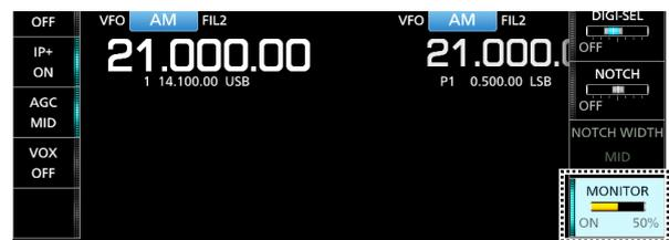
**HINWEIS:** Wenn Sie die im VOX-Menü eingestellte VOICE DELAY verwenden, schalten Sie die Monitor-Funktion AUS. Andernfalls entsteht ein Echo im gesendeten Ton.
