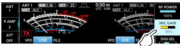
6. Berühren Sie das Messgerät erneut, um das COMP-Messgerät anzuzeigen.
