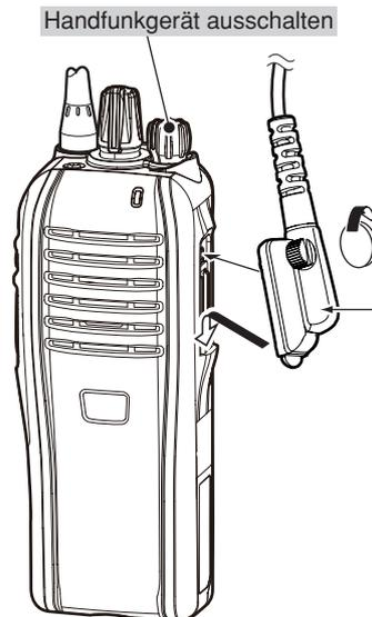
**VORSICHT:** Schraube gut festziehen, aber nicht überdrehen. Wenn sie nicht fest genug sitzt, kann evtl. Wasser in den Multi-Connector eindringen. Beim Überdrehen kann die Buchse bzw. das Gewinde beschädigt werden.
