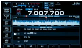
Mini scope function example • Frequency (top) • Mini scope (middle) • Memory keyer setting (Bottom)
