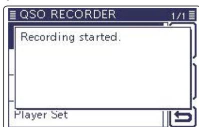
/// Wenn die Sprachspeicher-Funktion eingeschaltet wurde, bleibt sie auch beim Aus- und Wiedereinschalten des Transceivers eingeschaltet.
