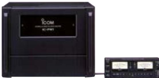
Dauerlastfeste 1-kW-Linearendstufe mit eingebautem automatischen Antennentuner. Bei Nutzung mit Icom-Transceivern automatisch abstimmend und automatische Bandumschaltung. Voll-QSK-fähig. Bedienteil separat von der Verstärker-/Netzteil-Einheit.
