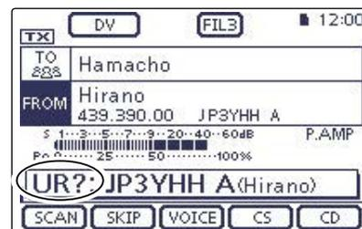
Bedeutet, dass der Gateway-Anruf vom „Hirano“-Repeater einwandfrei an den „Hamacho“-Repeater gesendet wurde
