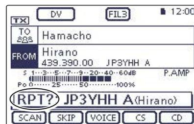
Bedeutet, dass der Gateway-Anruf vom „Hirano“-Repeater einwandfrei an den „Hamacho“-Repeater gesendet wurde, der „Hamacho“-Repeater aber von anderen Stationen belegt ist
