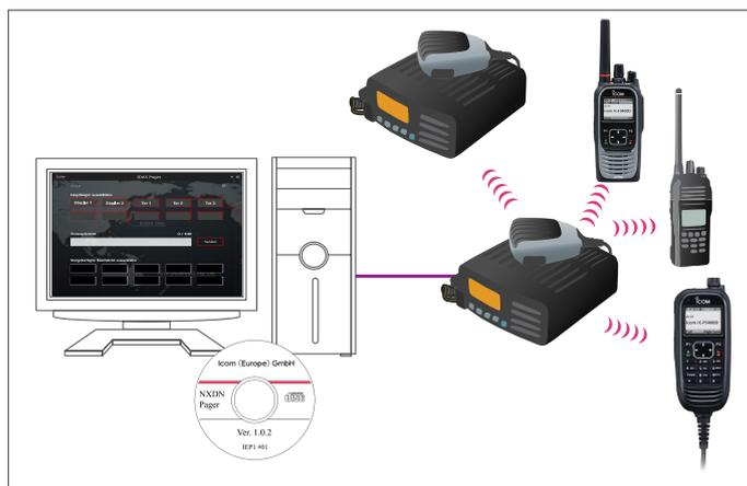
Mit der IEP-1 Pager Software lassen sich bis zu 10 Sende- bzw. Empfangsgeräte aus der IDAS-Produktreihe mit Display festlegen.
