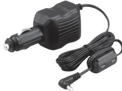
Erlaubt den Betrieb des Empfängers mit 12 V, die vom Zigarettenanzünder des Kfz entnommen werden können. Auch zum Laden des im Empfänger befindlichen Akku-Packs. Die Umsetzung auf 6 V erfolgt mit einem internen Wandler.
