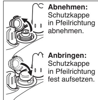
**WICHTIG: LASSEN SIE** die Abdeckung der **[SP MIC]**-Buchse am Funkgerät, wenn kein Lautsprechermikrofon benutzt wird. Durch die Abdeckung wird vermieden, dass die Anschlüsse der Buchse schmutzig werden oder die Funktion des Funkgerätes durch Feuchtigkeit in der Buchse beeinträchtigt wird. Wasser kann auch bei entfernter Abdeckung nicht in das Funkgerät eindringen.
