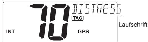
③ Nach dem Senden des Notalarms erwartet das Funkgerät auf Kanal 70 eine Rückmeldung.
