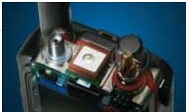
Lage des GPS-Empfängers im Inneren des Gehäuses
