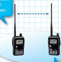
Direkte Simplex-Verbindungen sind im DV-Modus oder in FM ohne Repeater möglich.
