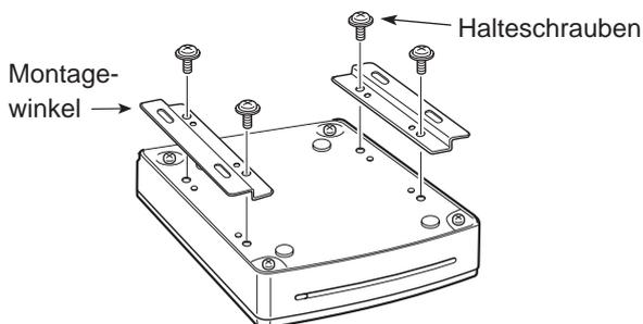
② Den Empfänger fest mit den vier mitgelieferten Schrauben (M5×20 mm) auf eine flache Unterlage schrauben, die mind. 10 mm dick ist und 2 kg tragen kann.
