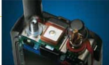
Lage des GPS-Empfängers im Inneren des Gehäuses
