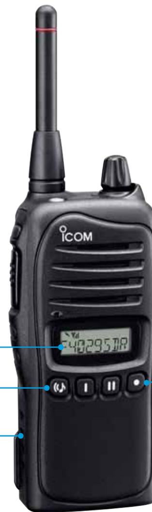
Kompakte Abmessungen (53 mm x 139 mm x 37 mm) und geringes Gewicht (320 g mit Standard-Akku BP-232N)
