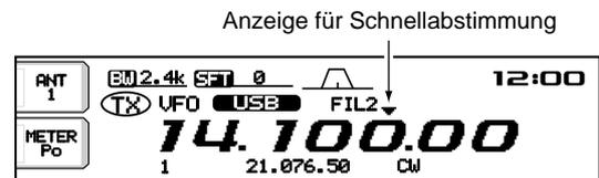
➔ Schaltet die 1-Hz-Abstimmung EIN und AUS, wenn die Schnellabstimmung ausgeschaltet ist und die Taste 1 Sek. gedrückt gehalten wird.
