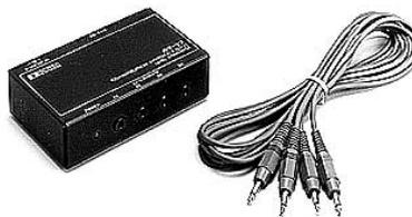
Für die Transceiver-Fernsteuerung über einen PC. Bis zu 4 Icom-Transceiver/Receiver können am CT-17 angeschlossen werden.
