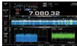
Minispektrumskop, NF-FFT-Skop mit Wasserfall und Oszilloskop
