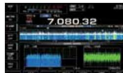
Minispektrumskop, NF-FFT-Skop mit Wasserfall und Oszilloskop
