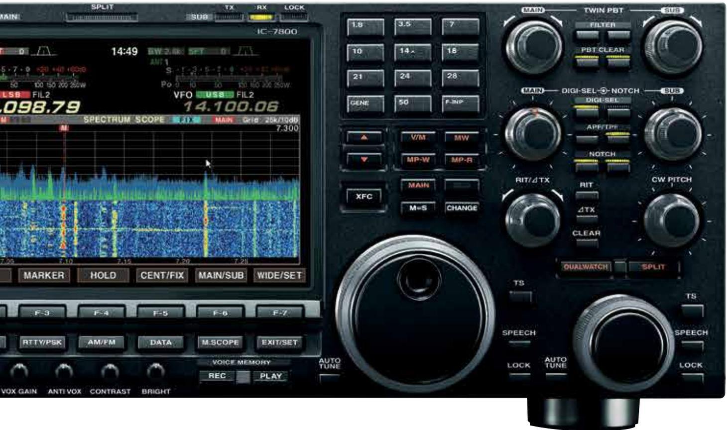
**[CW-Betrieb]** • DSP-gesteuerte CW-Signalhüllkurve • Multifunktionaler elektronischer Keyer mit einstellbarer Tastgeschwindigkeit, Punkt-Strich-Verhältnis und Paddle-Polarität • Wahlmöglichkeit der Filterform des APFs (soft/sharp)
