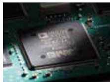
DSP-Chip ADSP-21369 32-Bit-Fließkomma-DSP mit 333 MHz interner Taktfrequenz max. Performance 2000 MFLOPS
