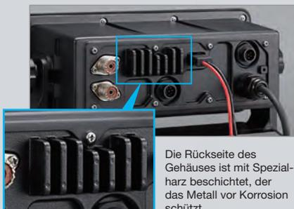
Die Rückseite des Gehäuses ist mit Spezialharz beschichtet, der das Metall vor Korrosion schützt.
