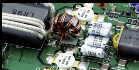
Detail der Endstufe
