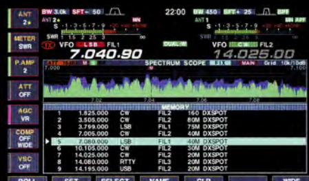
Display mit eingeblendetem Minispektrumskop
