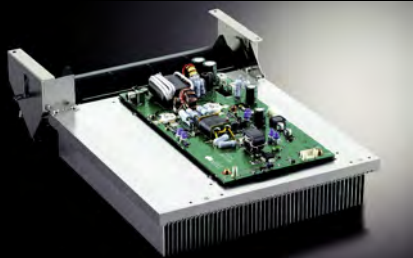
Endstufe und Kühlkörper
