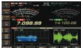
FFT-Spektrum mit Wasserfall und Oszilloskop
