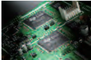
DSP für Sender und Empfänger TMS320C6726B (oben im Bild) Interne Taktfrequenz 266 MHz 32-Bit-Fließkomma-DSP Rechenleistung 1600 MFLOPS DSP für Spektroskop TMS320C6720 (Bildmitte) Interne Taktfrequenz 200 MHz 32-Bit-Fließkomma-DSP Rechenleistung 1200 MFLOPS
