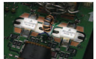
Leistungs-FETs in der Endstufe
