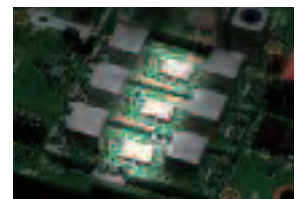
6-kHz-, 3-kHz- und 15-kHz-Filter der 1. ZF (von oben nach unten)
