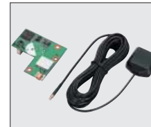
• UT-123 DIGITAL/GPS-EINHEIT Ermöglicht D-STAR-DV- und GPS-Betrieb.
